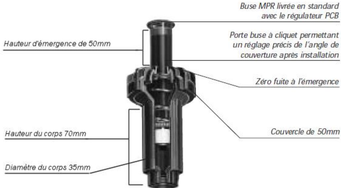
*Equipé d'un joint basse pression permettant une chasse des débris à la rétraction, la tuyère référence 570Z-2P est parfaite pour les petites pelouses et les espaces paysagers complexes.*
